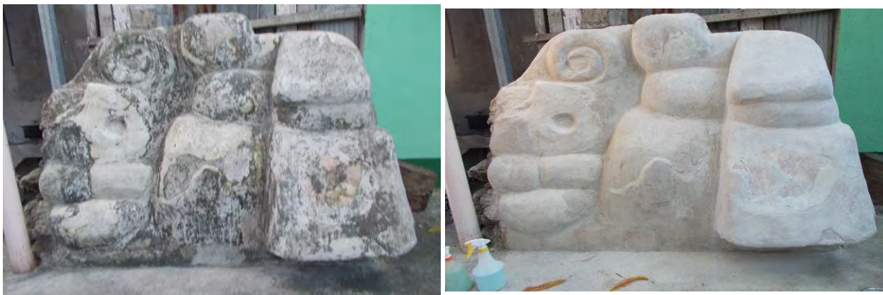
Figura 9 y 10: Réplica de mascarón en Santa Elena, Petén, donde se realizaron pruebas con productos nanotecnológicos y antihongos. (Fotografías: Enrique Monterroso )
