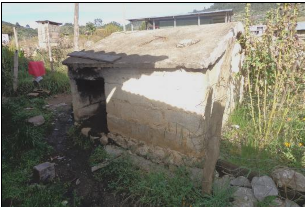
Figura 4. Temascal construido con block y terraza de concreto. Fotografía de López Garzona, 2012.
